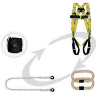
Kit Nacelle. Composé de : 1 harnais 2 points d'accrochages (W-FBH 12), 1 longe tressée longueur 1,5 m (W-BRL 281) avec 2 mousquetons acier à verrouillage à vis (W-112). Emballé dans un sac de rangement.
