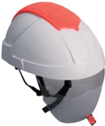
Casque de protection pour électricien contre l'arc électrique de court-circuit. Casque innovant avec écran panoramique entièrement escamotable. Coiffe en textile comporte 6 points d'attache, réglable en hauteur et une crémaillère permettant l'ajustement pour un tour de tête de 53 à 63 cm. Ecran en polycarbonate incolore anti-rayures.
