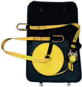
Ligne de vie horizontale temporaire composée d'une sangle de polyester de 30 mm équipée d'un tendeur à cliquet qui permet une tension facile de la ligne de vie entre deux traverses. Les deux extrémités sont munies d'un mousqueton en acier à verrouillage automatique.
