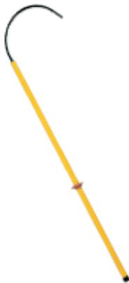
Perche de sauvetage à corps 45 kV avec garde de protection et crochet, employée pour le sauvetage d'un agent accidenté. Tension de test sur 300 mm : 100 kV. Crochet : en tube acier de 18 x 1,5 cm. Tension d'utilisation : 45 kV. Longueur totale sans crochet : 1,47 m. Longueur de la partie protégée (hampe) : 60 cm. Poids : 1,47 kg.
