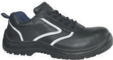
Chaussure basse S3 SRC en cuir pleine fleur grana mina, hydrofuge. Doublure : avec tunnel d'air respirante. Embout : composite. Semelle anti-perforation composite. Semelle de propreté respirante et anti-bactérienne. Semelle d'usure en PU/PU double densité compact anti-abrasion résistance à l'huile, anti-dérapante et antistatique. Liserés réfléchissants.
