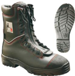
Chaussure cuir cheville avec un rembourrage en caoutchouc mousse. Tongue cuir matelassé. Semelle anti-perforation intermédiaire polyester, épaisseur : 4 mm. Semelle intérieure amovible antistatique. Semelle extérieure caoutchouc nitrile résistant à la chaleur jusqu'à 300 °C. Embout acier de 200 joules.
