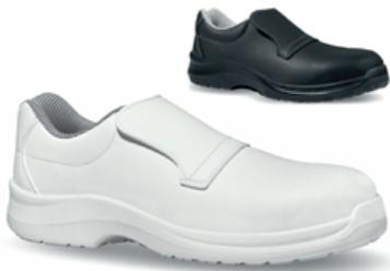
Tige : Safety Dry hydrofuge et respirante. Doublure : Wing Tex avec tunnel d'air respirante. Embout : AirToe composite, embout de sécurité perforé avec membrane respirante. Semelle amovible : White Ergo Dry, anatomique, revêtue d'un tissu respirant, antimycosique, et antifatigue. Semelle confort : souple PU. Semelle usure : PU compact antiabrasion, résistance à l'huile, antidérapante et antistatique. Chaussant : Natural Confort 11 Mondopoint.
