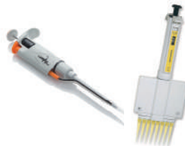
Micropipettes entièrement Autoclavables Fixes-Réglables 8 et 12 Canaux
