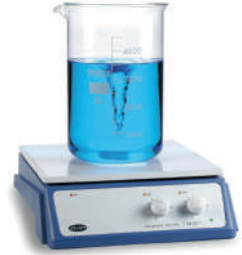
Agitateur magnétique chauffant ou non chauffant Plaque en métal ou céramique
